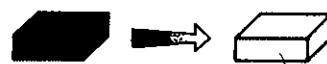
جسم سرد جسم گرم انتقال حرارت از جسم گرم به جسم سرد
