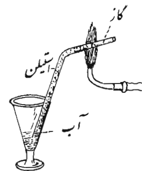
شکل ۵۷- بالا رفتن آب در لوله نشان می دهد که حجم گاز درون آن کم شده است.
