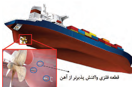
شکل ۱۲. چگونگی حفاظت کاتدی بدنه کشتی
