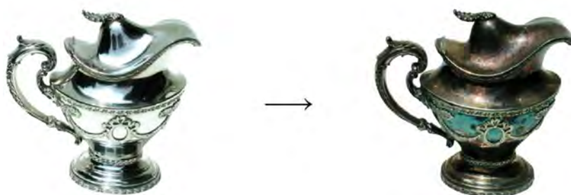
شکل ۲. ترکیب فلزات با اکسیژن (اکسایش)
