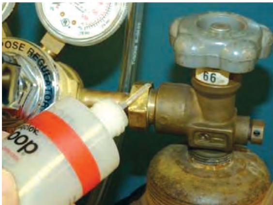
تست نشتی بعد از بستن رگولاتور
