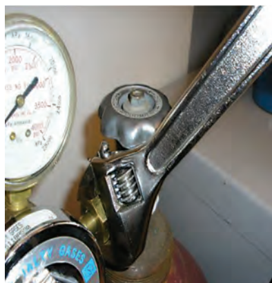
بازکردن رگولاتور از کپسول
