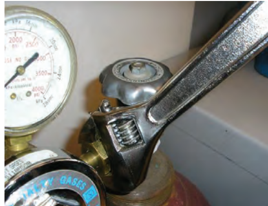
نحوه بستن رگولاتور به کپسول
