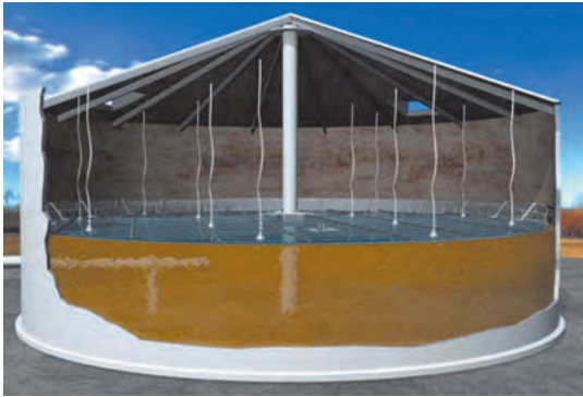
۴-۱۸ مخازن سقف شناور درونی
