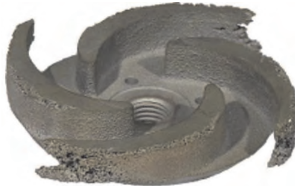
شکل ۱۸-۳ آسیب‌دیدگی پروانه پمپ در اثر پدیده کاویتاسیون
