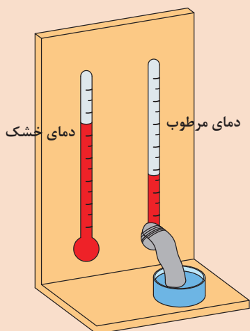
شکل ۱۱- آزمایش تعیین رطوبت نسبی هوا
