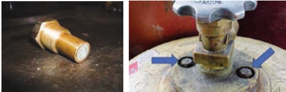
شکل ۳۳- مجرای ذوب شدنی روی شانه یک سیلندر گاز تحت فشار و یک مجرای ذوب شدنی مجزا قبل از نصب
