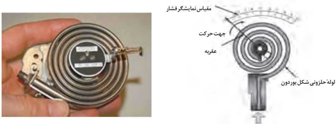
شکل ۲۲- لوله بوردون از نوع حلزونی
