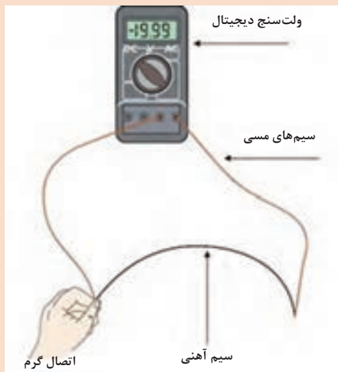
شکل ۲۲- ساخت یک ترموکوپل ساده
