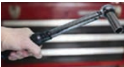
شکل ۲۴- آچار ترک یا آچار گشتاور
