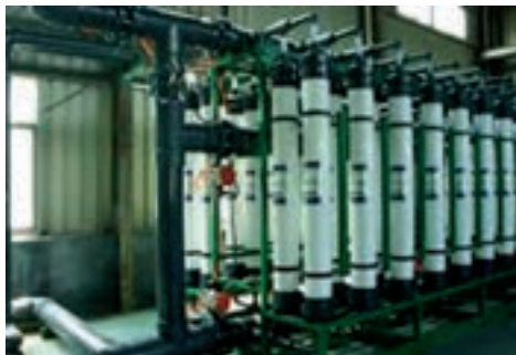
شکل ۱۰- نمایی ساده و واقعی از فرایند اولترافیلتراسیون
