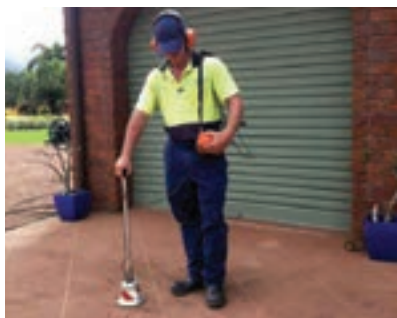
شکل ۱۰- تشخیص نشتی آب با دستگاه نشت یاب فراصوت ۱
