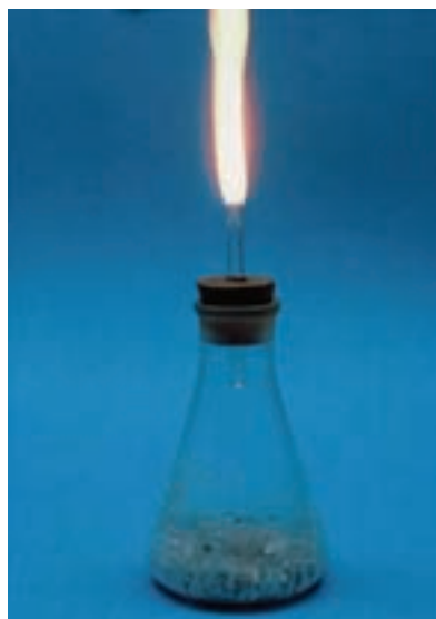
شکل ۱۰- واکنش کلسیم کربید با آب گاز اشتعال پذیر استیلن را تولید می‌کند.
