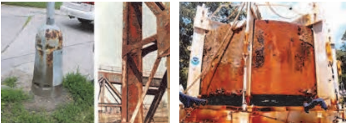
شکل ۵- نمونه‌هایی از خوردگی جوی
