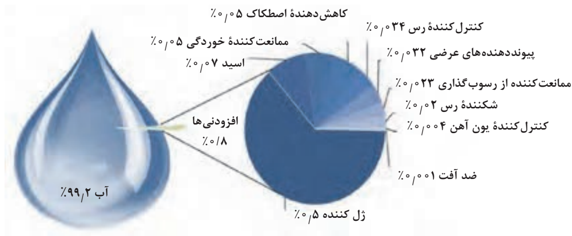
شکل ۲- ترکیب نسبی سیال شکننده لایه‌های خاک رس.
