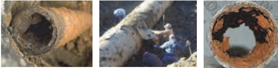
شکل ۴- نمونه‌ای از خوردگی لوله‌های دفن شده
