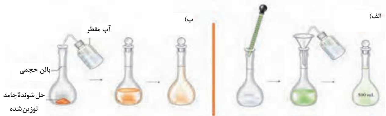
شکل ۱- تهیه محلول با نرمالیت مشخص از (الف) نمونه مایع (ب) نمونه جامد
