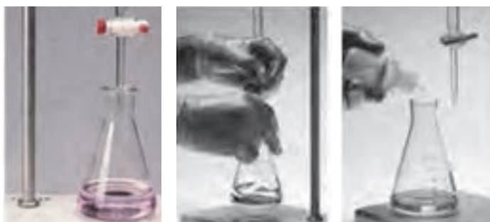
شکل ۱۱- شیوه سنجش حجمی محلول سرکه با سود استاندارد
