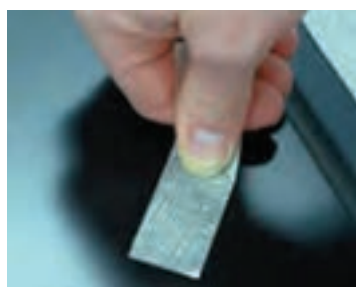
شکل ۲۳- مراحل انجام آزمایش چسبندگی به روش صلیبی
