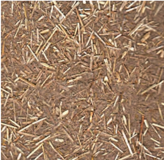
شکل ۳۱ - کاه‌گل یک نوع کامپوزیت طبیعی
