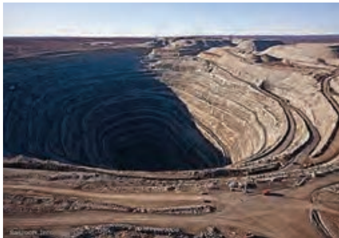
شکل ۲۷- چاله‌های پلکانی در یک معدن روباز
