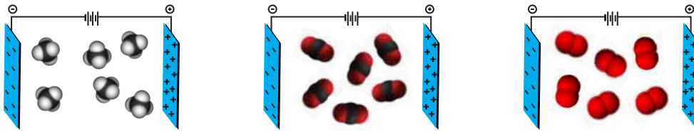
شکل ۱۶- رفتار مولکول‌های O_2 ، CO_2 و CH_4 در میدان الکتریکی
