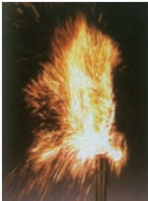
شکل ۱۰- سوختن گرد آهن. اغلب فلزها مانند آهن در شرایط مناسب با گاز اکسیژن می‌سوزند.
