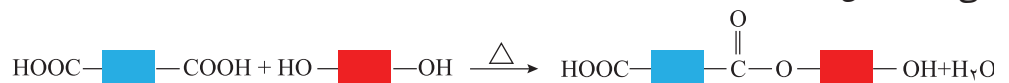
شکل ۱۴- الگویی از واکنش استری شدن بین یک کربوکسیلیک اسید و الکل دو عاملی
