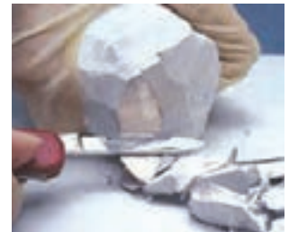
شکل ۵- الف) جلای نقره ای فلز سدیم در مجاورت هوا به سرعت از بین می رود و سطح آن کدر می شود.
