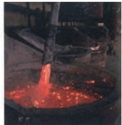
شکل ۱۸- فرایند هال برای تولید آلومینیم از \text{Al}_2\text{O}_3
